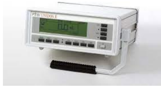
Foto 3: Electrómetro Patrón Secundario LSCD-GUA.
