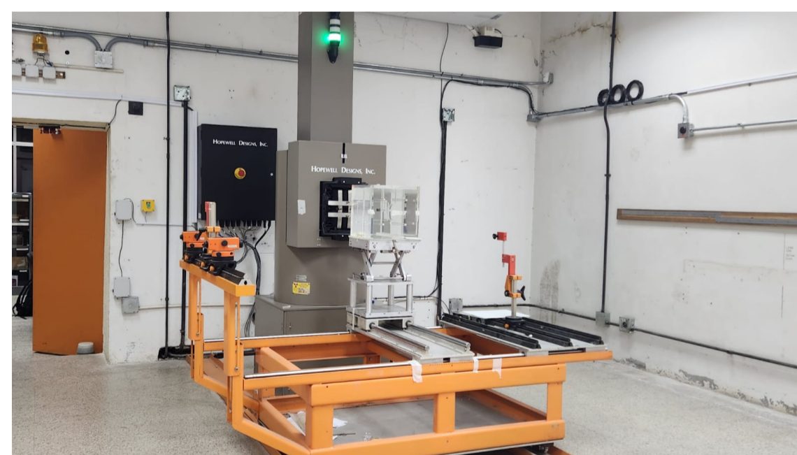
Figura 1: Irradiador de rayos gamma por ^{60}\text{Co} , Hopewell Designs G-100.
